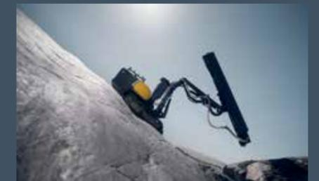
SmartROC T30 R은 동급 장비로는 강력한 성능을 자랑합니다. Volvo Penta 디젤 엔진 (105kW/143마력)과 함께 160 또는 250cc의 COP SC19 HF 착암기와 초당 80리터에어를 생산하는 컴프레서가 결합되어 가장 험난한 암반 조건에서도 작업할 수 있습니다.
